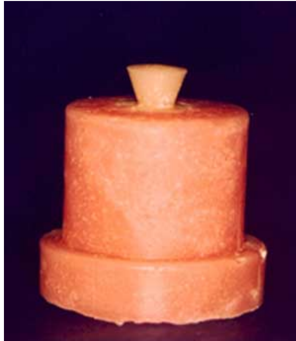
Figura No 2 Cono invertido de cemento dual polimerizado y cementado sobre la superficie de cerámica tratada.
