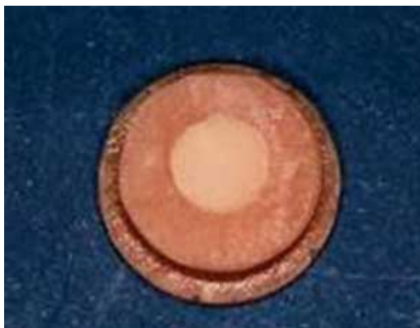
Figura No 1 Cilindro de cerámica prensada incluido en resina acrílica autopolimizable.
